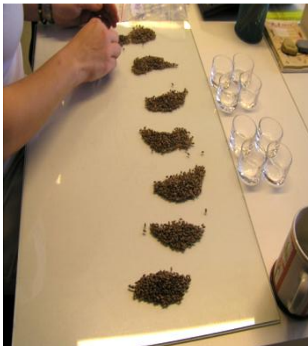
Slika 111. Određivanje mase 1000 sjemenaka
